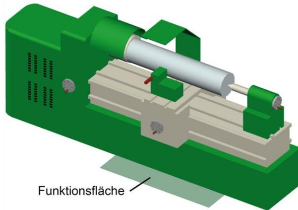
Abb. 9: Funktionsfläche für den Schlitten einer Drehmaschine
